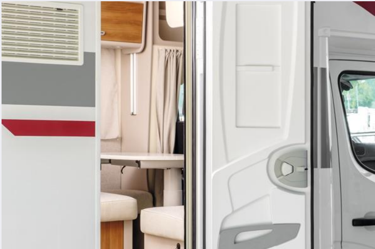
Porta di ingresso con controstampata
